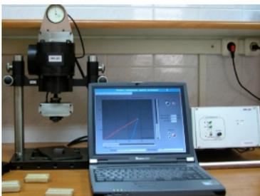
Современные приборные комплексы и математический аппарат позволяют определять механические свойства металла безобразцовым экспресс-методом. Применение этого метода обеспечивает мониторинг механических свойств металла оборудования в процессе эксплуатации.
