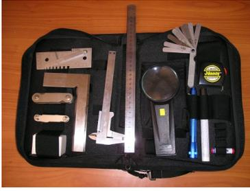
Контроль является одним из основных методов, применяемых при диагностировании оборудования. Метод позволяет выявлять поверхностные дефекты металла, такие как трещины, язвенную коррозию, волосовины, а так же качество исполнения узлов и элементов оборудования.
