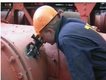
Исследования позволяют оценить наличие отклонений и степень деградации структуры металла оборудования в процессе его эксплуатации. Работы проводятся как в лабораторных условиях, так и на действующем оборудовании методом реплик и с применением переносных микроскопов.
