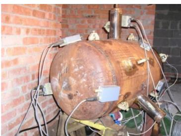
Метод основан на регистрации акустических сигналов, излучаемых растущими трещинами, свищами или утечками. Метод позволяет оперативно провести контроль оборудования и с достаточной точностью локализовать области дефектов для дальнейших исследований.
