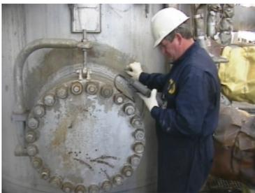
Измерение толщины металла проводится с целью выявления зон коррозионного и эрозионного износа. Полученные результаты служат исходными данными при проведении нормативных и уточненных расчетов прочности и ресурса в экспертизе промышленной безопасности.
