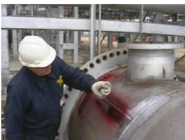
Метод является одним из высокопроизводительных и эффективных при выявлении поверхностных дефектов. Капиллярная дефектоскопия используется с целью уточнения и документирования дефектов, выявленных в процессе визуального и измерительного контроля.
