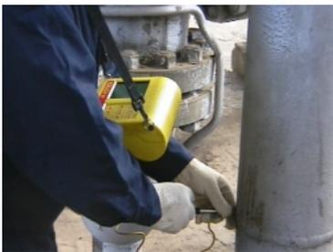
Измерение твердости является обязательной процедурой при оценке степени деградации металла оборудования в процессе эксплуатации. Применение переносных твердомеров позволяет определить твердость металла на действующем оборудовании.
