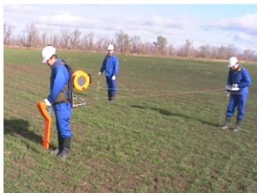
Электрометрическое диагностирование позволяет с достаточной точностью выявлять повреждения изоляционного покрытия подземных трубопроводов, оценивать эффективность системы электрохимической защиты и определять объемы необходимых ремонтных работ.
