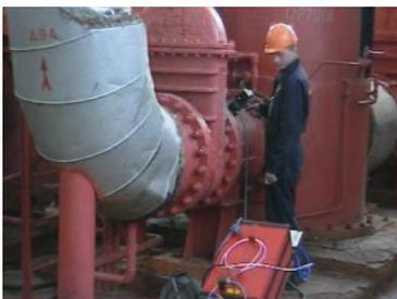
Безобразцовый экспресс-анализ химического состава металла элементов оборудования производится без вывода оборудования из эксплуатации и позволяет выявить несоответствие материального исполнения требованиям проекта и нормативно-технической документации.
