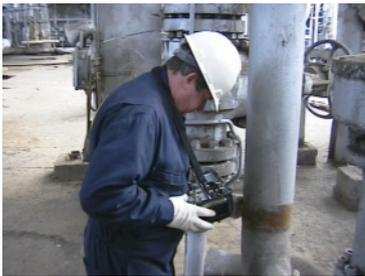
Вихретоковый метод позволяет производить контроль поверхности без удаления лакокрасочного покрытия. Преимуществом метода является возможность его применения в условиях высокой влажности, низких или высоких температур объекта контроля.
