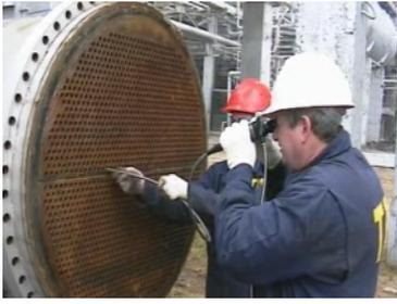
Неразрушающий контроль в труднодоступных местах производится с применением эндоскопов и бороскопов. Возможности применяемого цифрового оборудования обеспечивают достоверное выявление дефектов, измерение их размеров, документирование и последующий анализ.
