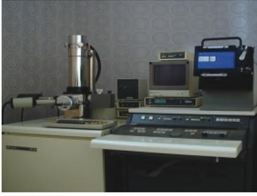
Фрактографические исследования позволяют достоверно определить причины разрушения элементов оборудования по результатам анализа поверхностей изломов. Качество анализа обеспечивается применением современных фрактографических и электронных микроскопов.
