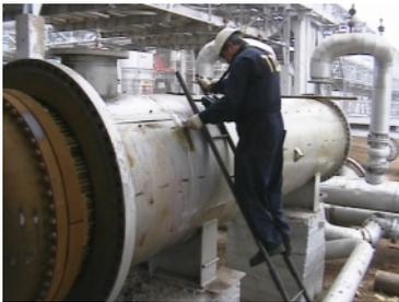
Ультразвуковой контроль сплошности основного металла и сварных швов производится с целью выявления скрытых дефектов и их оценки. На предприятии применяются ультразвуковые дефектоскопы с памятью настроек и результатов измерений, а также автоматизированные сканирующие системы.
