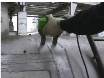
Метод является одним из наиболее эффективных и высокочувствительных к поверхностным и подповерхностным дефектам и позволяет обнаруживать непровары сварных соединений, закаты, волосовины, трещины различного происхождения и другие дефекты и несплошности металла.
