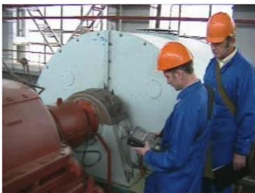
Обследования НКО и другого оборудования позволяют своевременно выявить износ узлов и элементов, определить их состояние и запланировать ремонт. Обследования трубопроводов, сосудов и аппаратов производятся для уточнения величин динамических воздействий и нагрузок.
