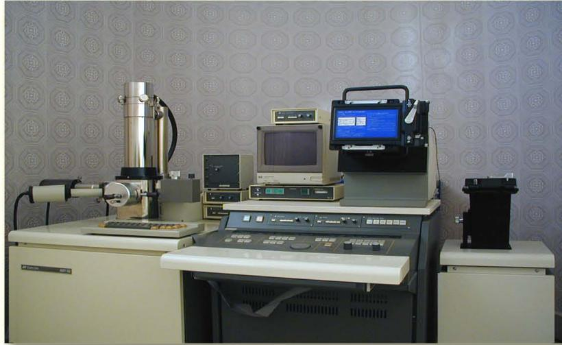
Сканирующий электронный микроскоп TOPCON
