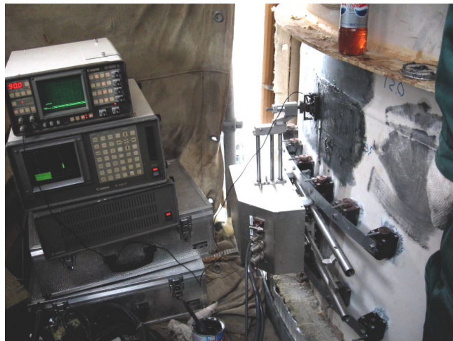
Работа самоходного сканера (сканирование обечайки) (колонна регенерации амина, КПК, КРО BV)
