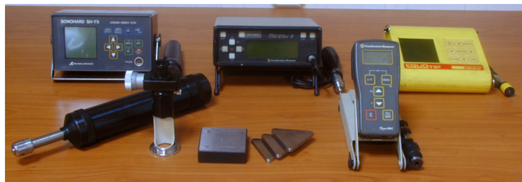
Для измерения твердости ОАО «Техдиагностика» использует различные приборы, реализующие методы Бринелля, Роквелла, Виккерса, Лейба и UCI
